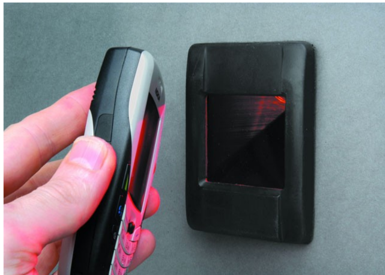
Abbildung 14: Das Gavitec MD-20 beim Einlesen eines 2D-Barcodes direkt vom Handydisplay. Foto © Gavitec AG
