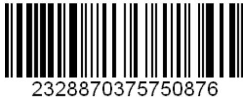
Abbildung 11: Code128-Darstellung der Ziffernfolge "2328870375750876"
